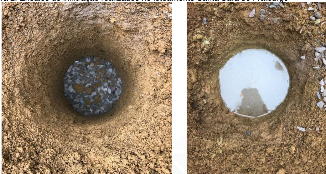
Figura 2: Ensaios de infiltração realizados no loteamento Santa Sara de Fraiburgo
